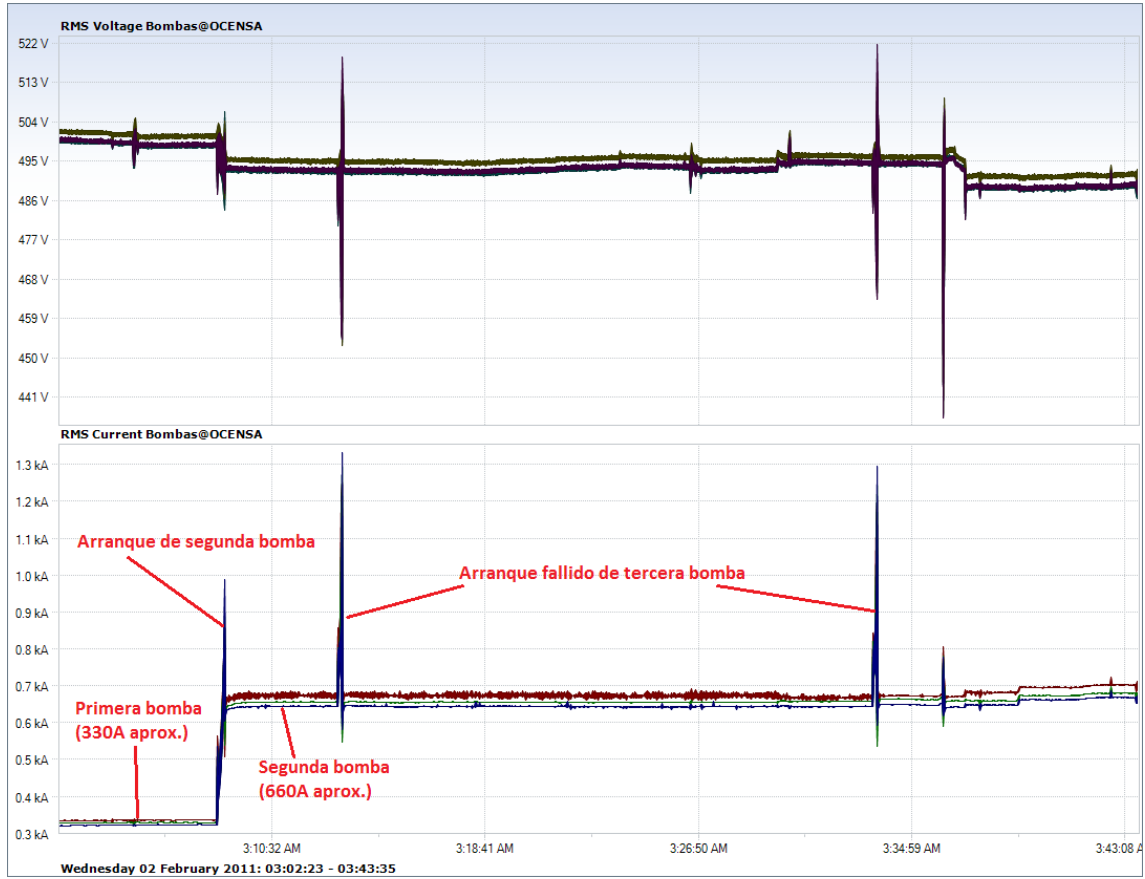
FIGURA 3 – TENTATIVA DE PARTIDA DA TERCEIRA BOMBA (COM FALHA)
