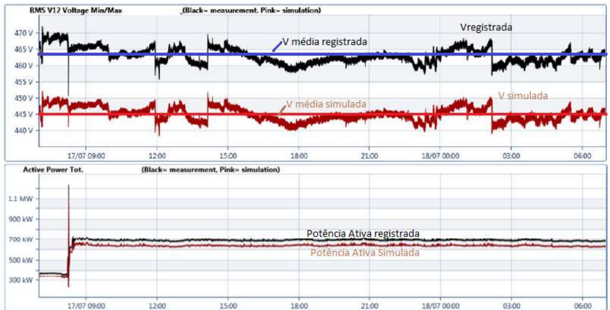
Figura 1 - Comportamento da Potência Ativa com variação da tensão de a limentação em instalação de grande complexo comercial [2]
