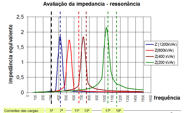
FIGURA 12– Avaliação da ressonância paralela
